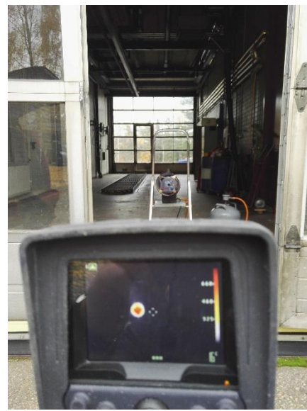
Kuva 6 Lämpökamera havaitsee lämmönlähteen
