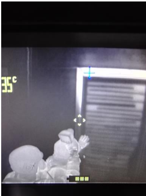
Kuva 4 Palavan huoneiston paikallistaminen lämpöjälkeä hyödyntäen
