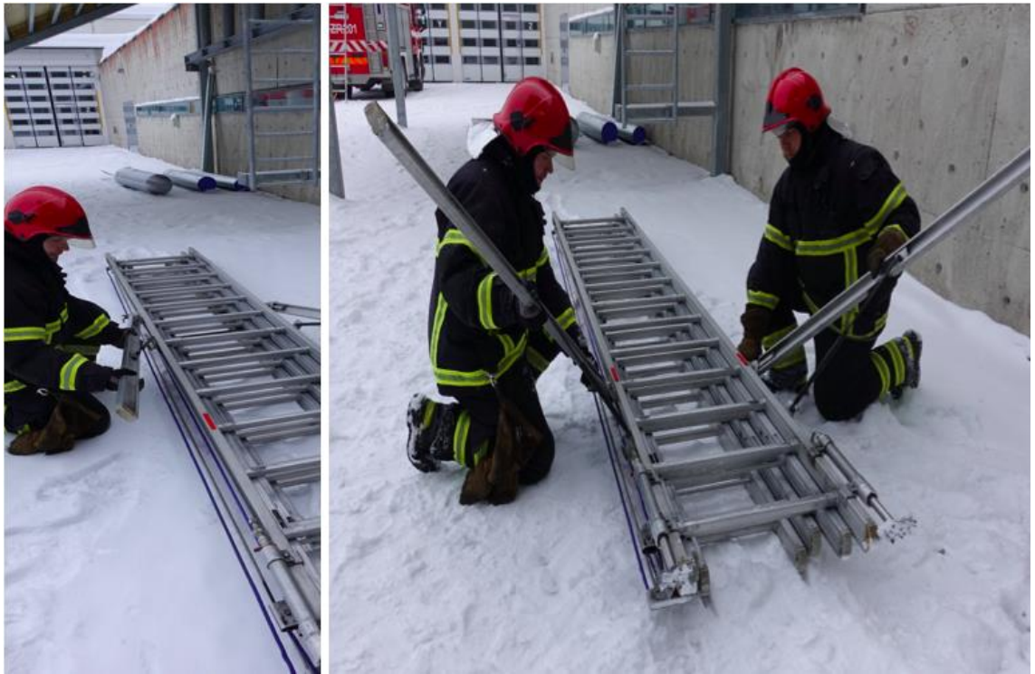
Kuva 18. Ykkönen ja kakkonen asettuvat tikkaan kummallekin puolelle ja kääntävät tukijalat auki asentoon. Tukijalat siirretään lukitusvipuja avaamalla merkityille paikoilleen (noin neljännes tyviosan tikaspuolan kohdalle).
