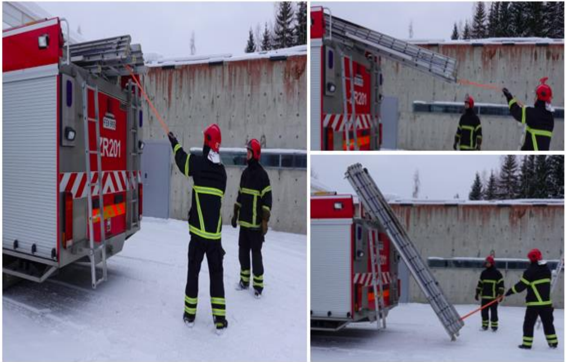
Kuva 10. Kakkonen vetää vetonarusta kuljetustelineen ja tikkaan alas maahan.
