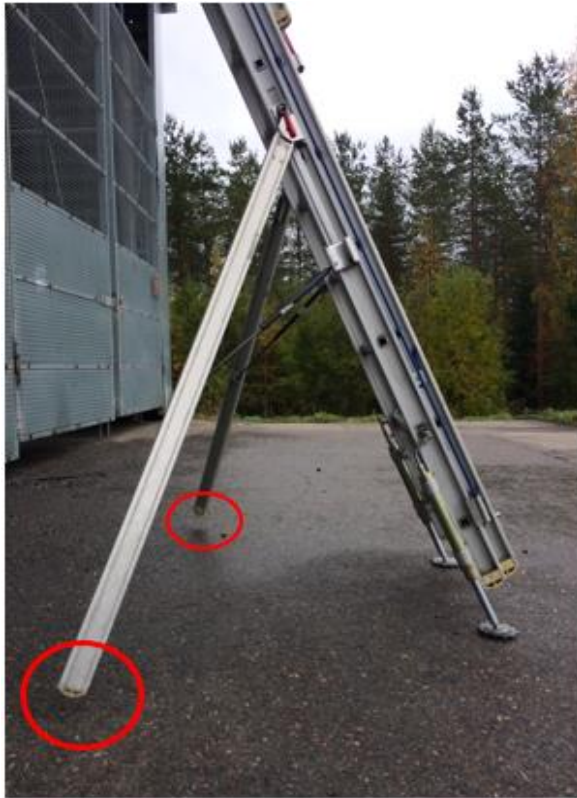
Kuva 4. Tukijalat irti maanpinnasta
