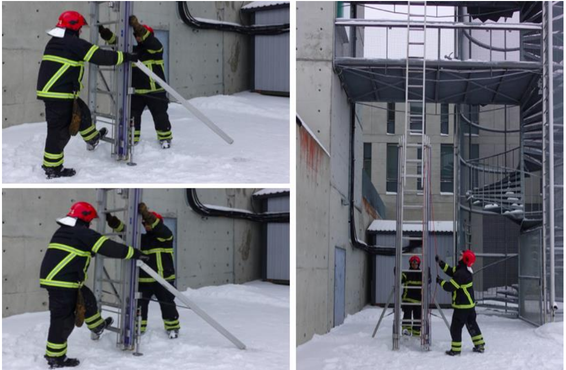
Kuva 34. Kakkosen keventäessä tikkaita ykkönen asettaa tukijalat maahan ja lukitsee ne. Ykkönen siirtyy tikkaiden sivustalle ja laskee tikasosat järjestyksessä (alempi keskiosa, ylempi keskiosa ja latvaosa).
