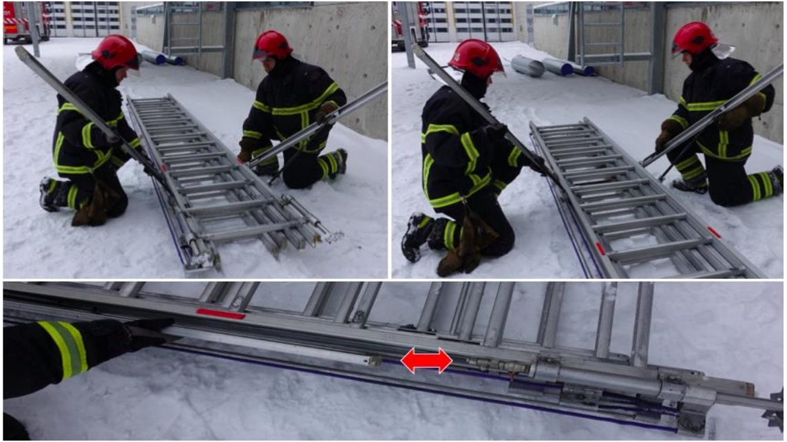
Kuva 36. Tikkaan tukijalat taitetaan tikasreisien sivuille. Tukijalka ei saa taittua pinnantasauslaiteiston päälle.
