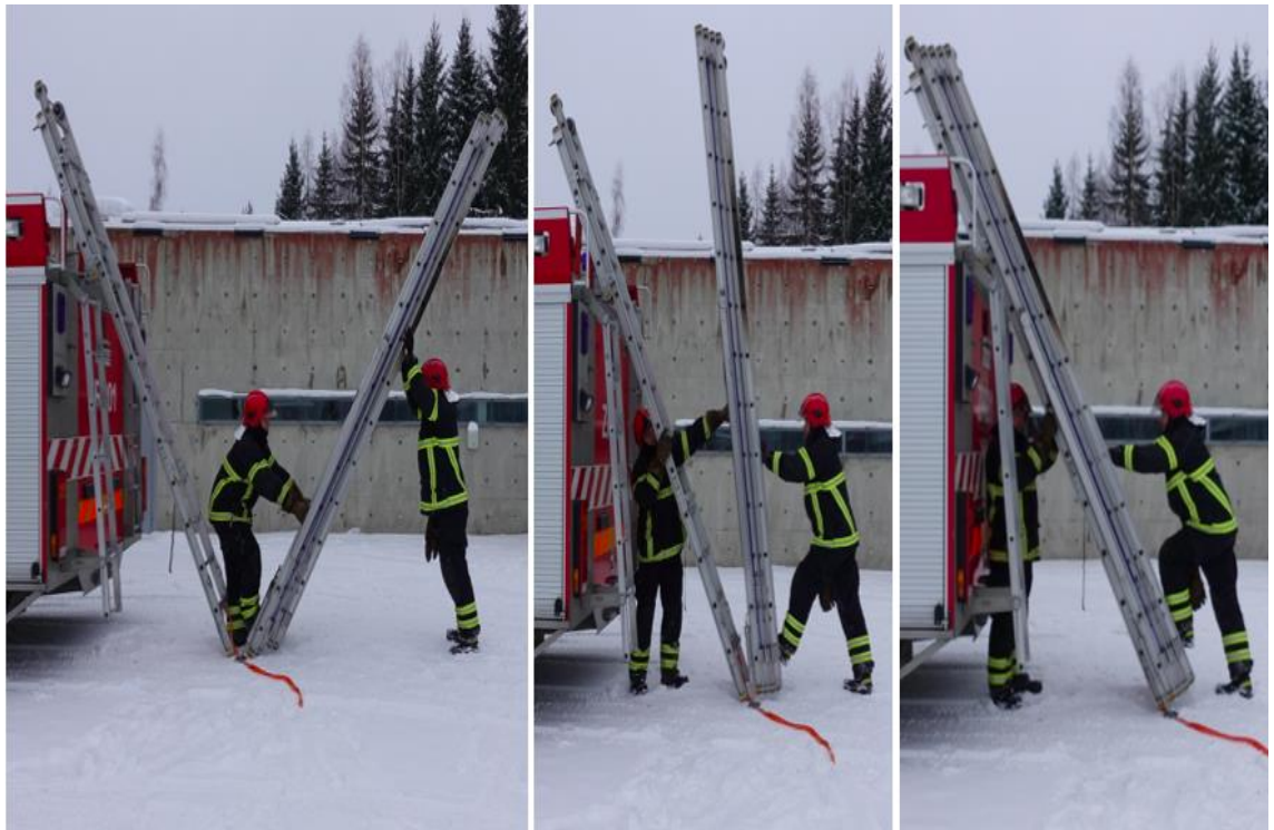
Kuva 39. Tikkaat käännetään kuljetustelinettä vasten.
