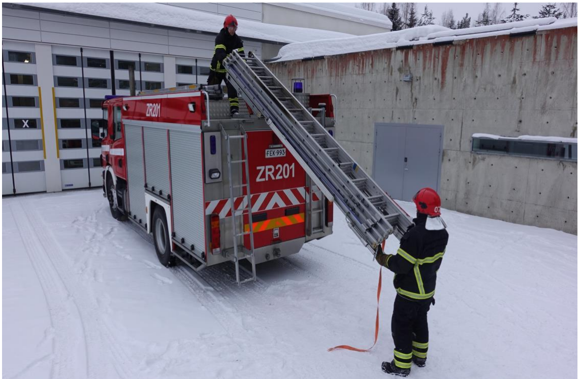
Kuva 42. Tikkaat nostetaan kuljetustelineessä auton katolle.
