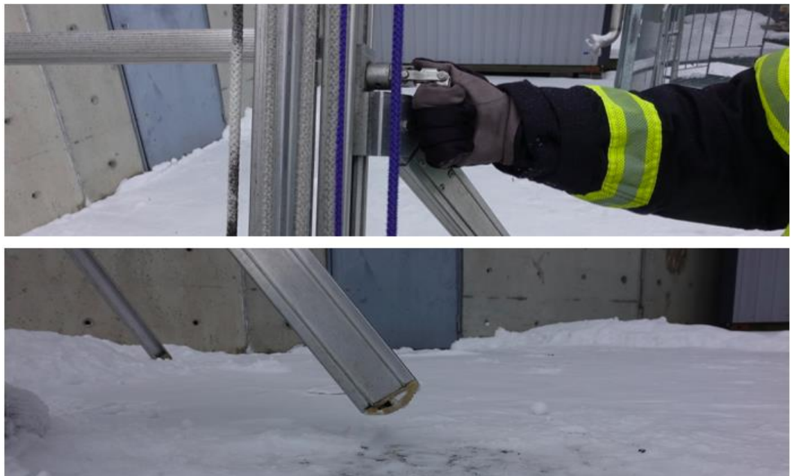
Kuva 29. Tukijalkojen ja kovan maanpinnan väliin jätetään valmistajan ohjeiden mukaan 2 cm väli. Tikkaiden oikea kulma tarkastetaan tikasreiden sivussa olevasta merkinnästä. Kulman tulisi olla valmistajan ohjeistama 75 astetta.
