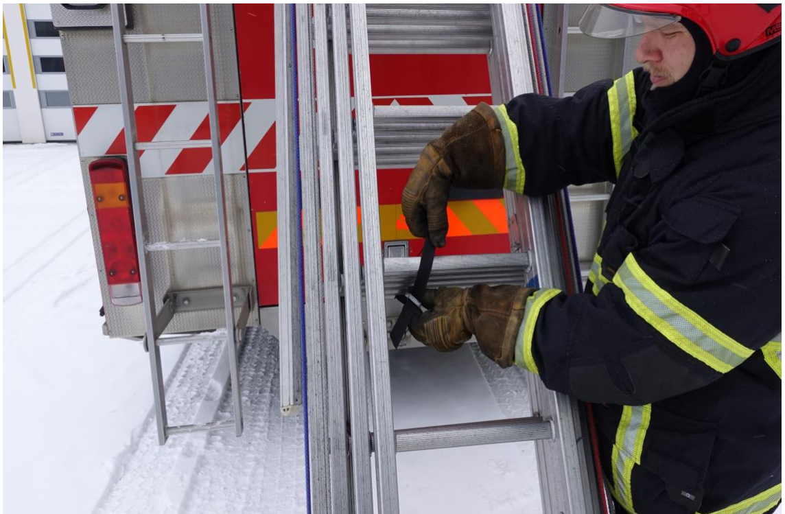
Kuva11. Ykkönen avaa tikkaiden kiinnityshihnan.
