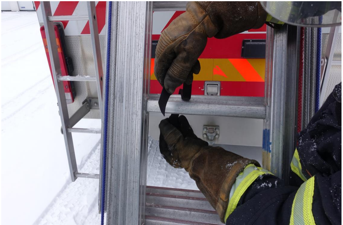
Kuva 41. Ykkösen kiinnittää tikkaan kiinnityshihnan kakkosen noustessa auton katolle. Katolle kiivettäessä on noudatettava varovaisuutta.
