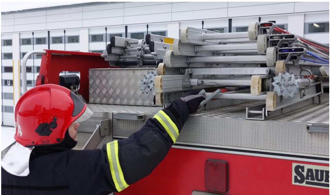
Kuva 9. Kakkonen avaan tikkaiden kuljetustelineen lukitusvivun.
