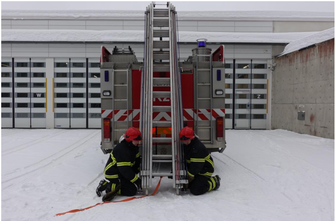
Kuva 40. Ykkönen ja kakkonen siirtyvät kuljetustelineen sivulle ja laskeutuvat korkeaan polviasentoon. Tämän jälkeen he ottavat toisella kädellä kiinni kuljetustelineestä, toisella kädellä tikasreiden tyvestä ja nostavat yhdessä tikkaat kuljetustelineeseen. Tikkaat nostetaan työturvallisesti selkä suorana.
