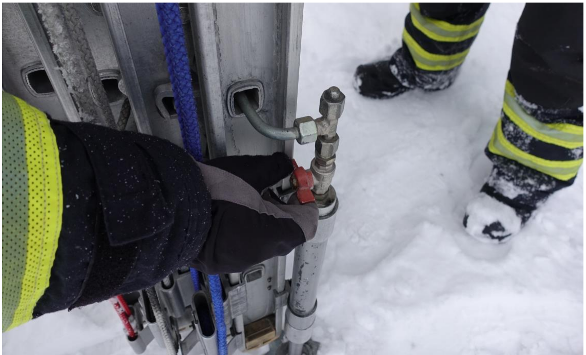
Kuva 23. Kun tikkaat ovat sivuttaissuunnassa suorassa, ykkönen sulkee pinnantasauslaitteiston hanan.
