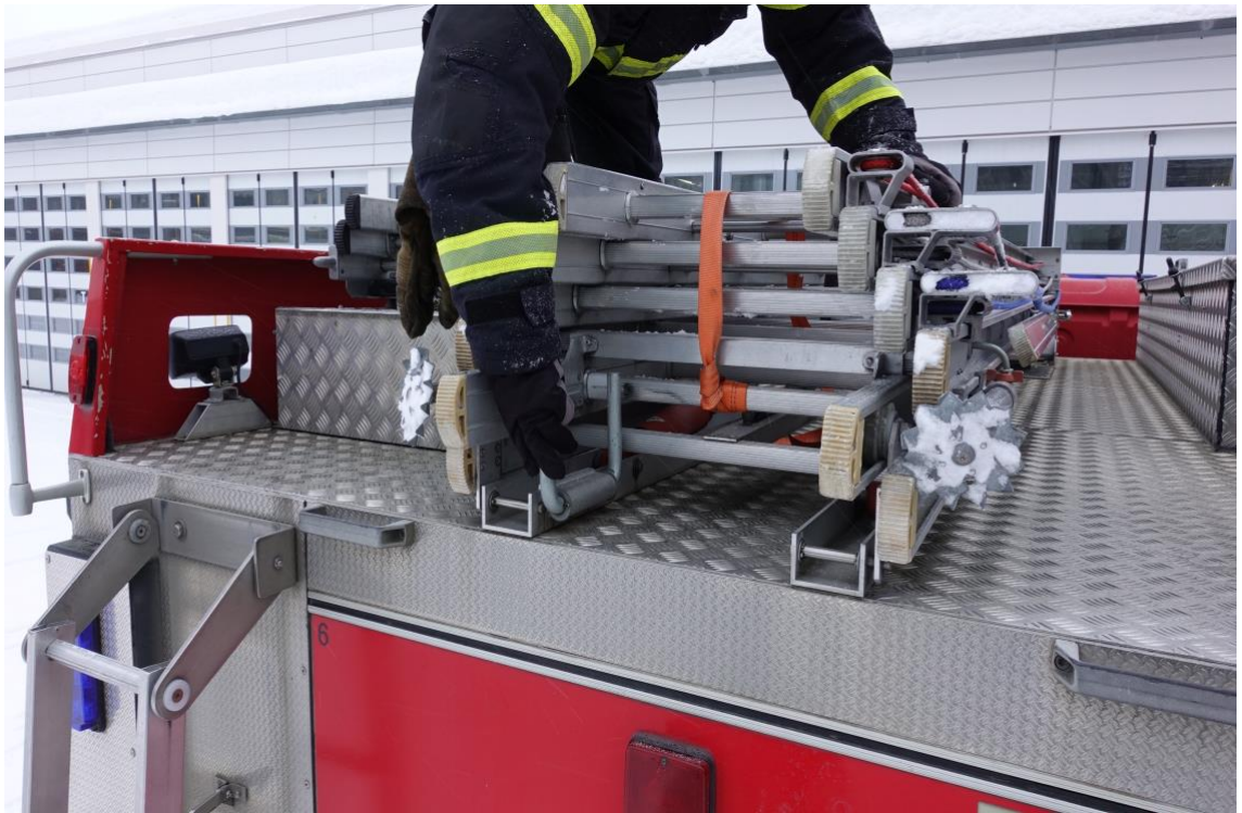
Kuva 43. Tikkaat ja kuljetusteline lukitaan kuljetusasentoon.
