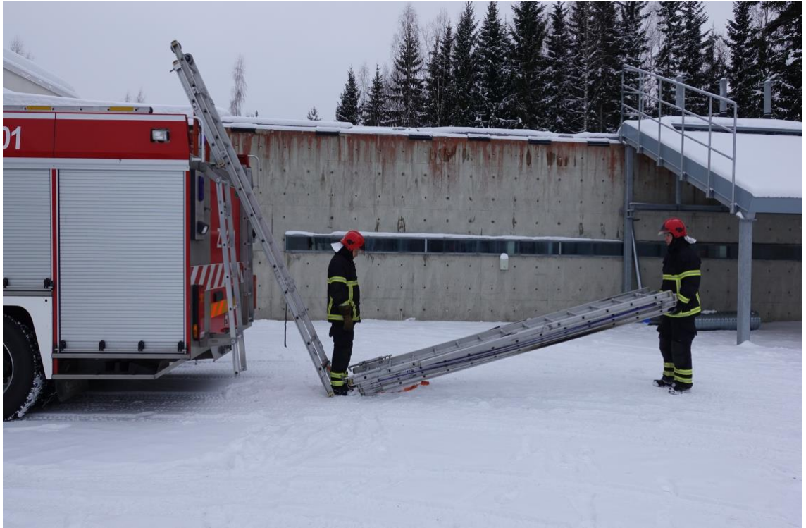
Kuva 13. Tikkaat lasketaan maahan ykkösen jäädessä kannattelemaan tikkaan latvaosaa.
