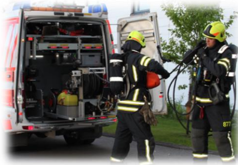
Kuva 20. UHPS kärkiyksikössä (Latvala).
