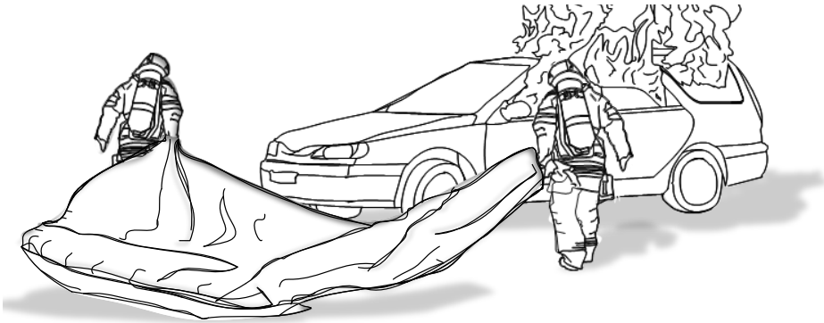
Kuva 44. Autopalon sammutus autonsammutuspeitteellä (Kuikka).
