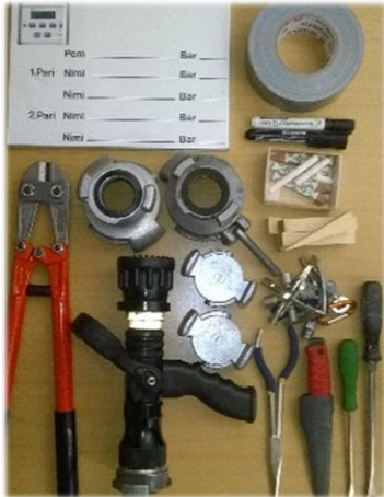
Kuva 5. Korkeiden rakennusten varustesetti, malli Helsinki (Ahola).
