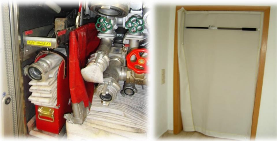
Kuva 19. Vasemmalla savuverho (Smoke Stopper) on valmiina pumpun vieressä (Siitonen), oikealla verho on asennettuna avoimeen oveen (Reick).
