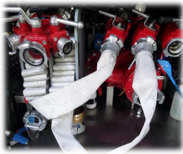
Kuva 8. Kiinteä autopumppu, jossa varmennettu pääjohto on valmiiksi liitetty pumppuun sekä vuorjakoliittimeen (Pelastusopisto).
