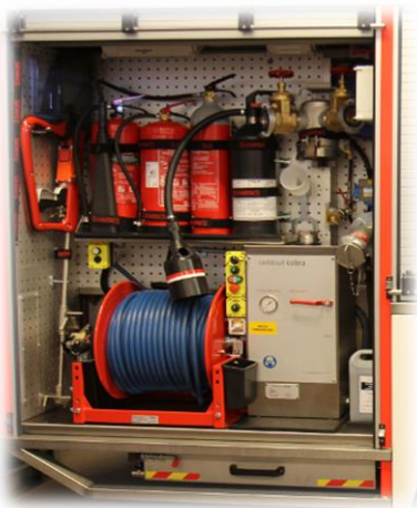
Kuva 15. Käsiammuttimia sammutusautossa, lisäksi sammutusautossa on integroitu sammutinleikkuri (Latvala).
