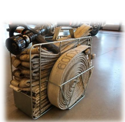
Kuva 10. Hyökkäyskehikko, jossa työjohtoa on kehikolla sekä kieppi työvarana (Latvala).
