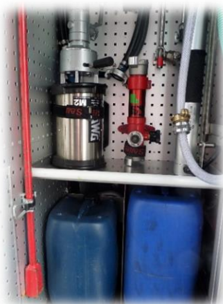
Kuva 11. Vasemmalla armatuuriikalustoa, oikealla vaahtokalustoa (Pelastusopisto).
