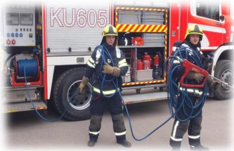
Kuva 21. Sammutinleikkuri, Cobra raivausautossa (Latvala).
