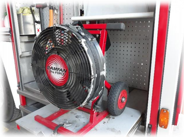
Kuva 18. Sähkökäyttöinen savutuuletin (Pelastusopisto).
