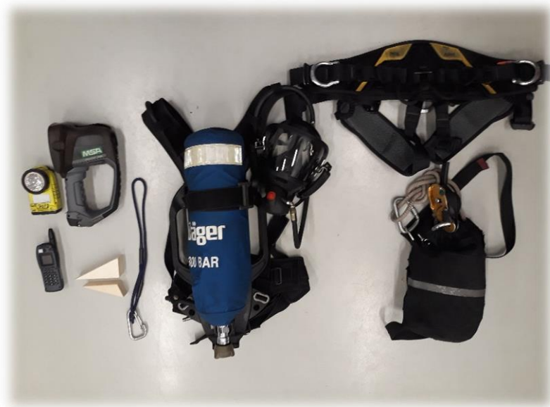
Kuva 3. Pelastusryhmän jäsenen henkilökohtaista perusvarustusta savusukellustilanteessa (Pelastusopisto).
