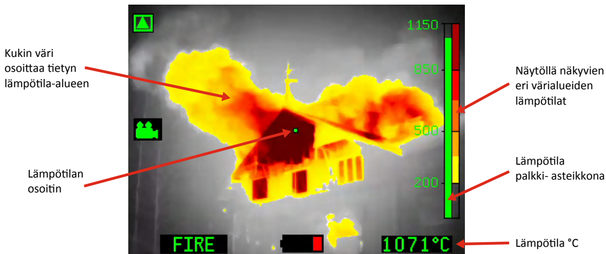
Kuva 59. Lämpötilojen mittaaminen lämpökameralla.
