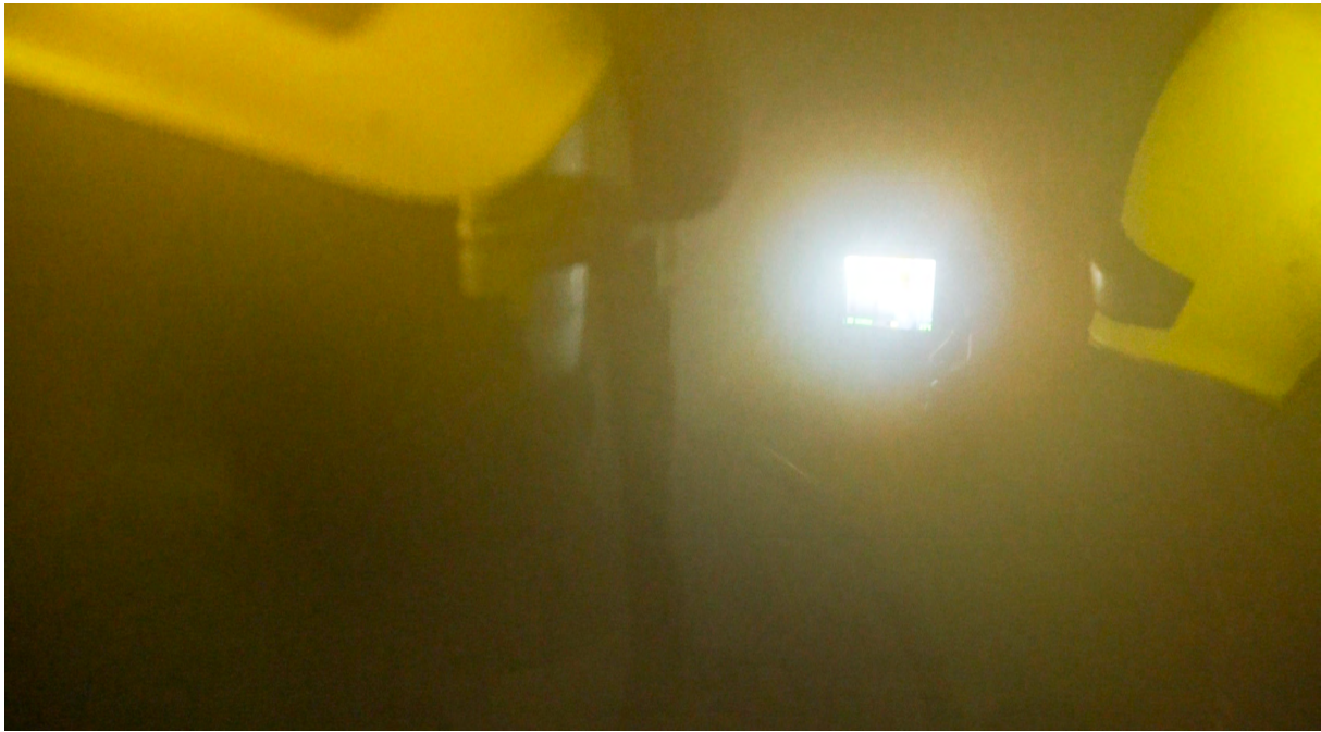
Kuva 61. Vesihöyry häiritsee lämpökameralla havainnointia.
