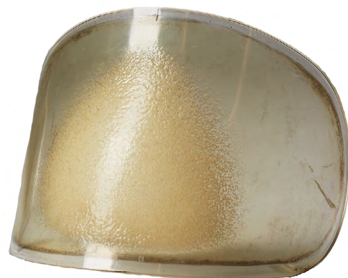
Kuva 41. Kasvo-osan vaurioitunut visiiri.
