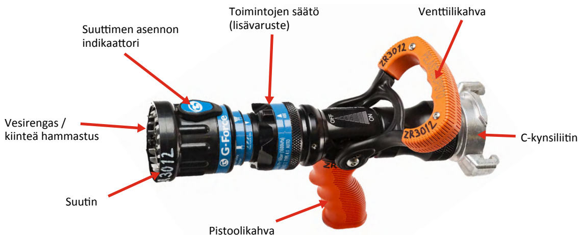
Kuva 65. Suihkuputken osat.
