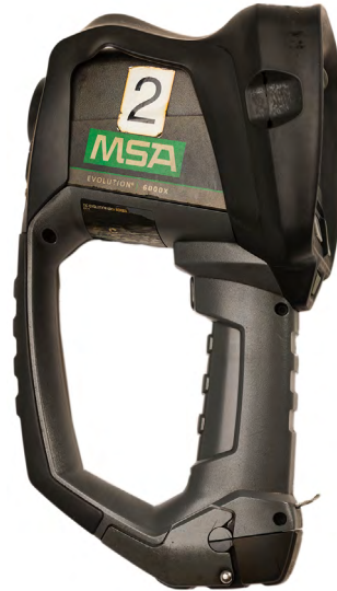
Kuva 58. Savusukelluskäyttöön tarkoitettu lämpökamera.
