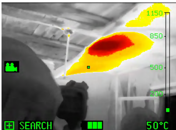
Kuva 87. Lämpökameralla havaitaan kuumat kohdat palon jälkisammutuksessa.
