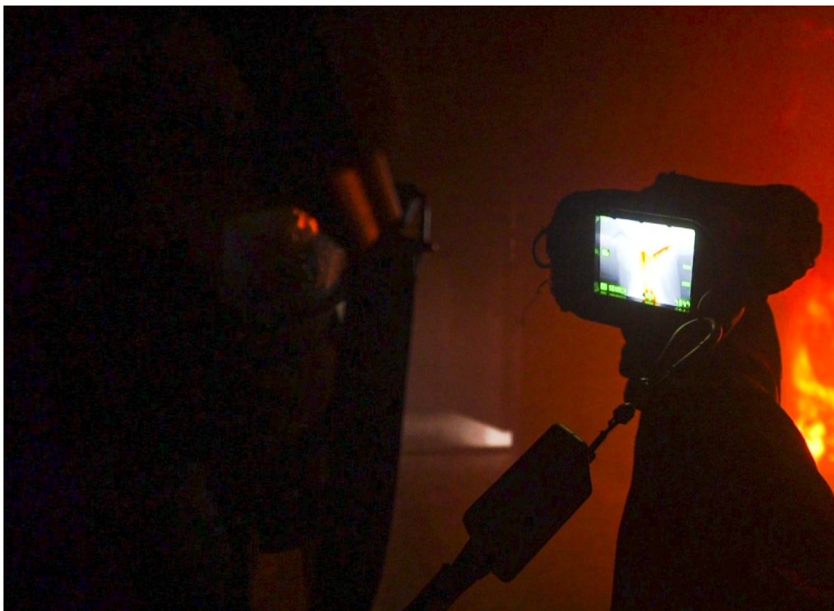
Kuva 78. Lämpökamera on hyvä kiinnittää varusteisiin kelautuvalla kiinnittimellä.
