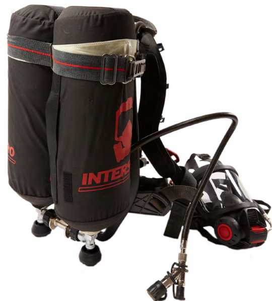
Kuva 57. Osassa paineilmahengityslaitteita lisäilmaliittimet saa vetäistyä olkahihnan pidikkeistä irti, jolloin liittimiin tulee kätevää noin metri letkua (Interspiro).
