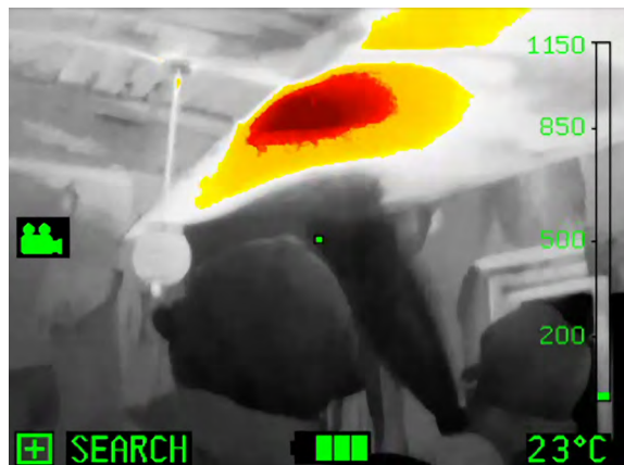
Kuva 88. Kuumiin kohtiin suihkutettu vesisuihku näkyy kameran näytöllä mustana.
