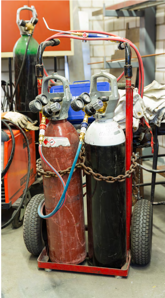
Kuva 50. Hitsauskaasusäiliöitä, etualalla punaruskea säiliö sisältää asetyleeniä ja mustavalkoinen säiliö sisältää happea.
