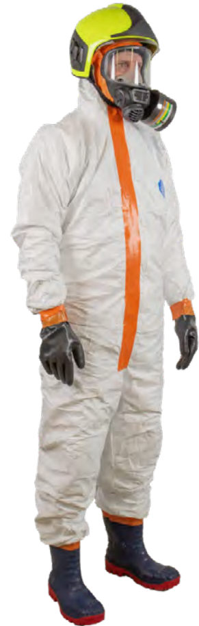
Bild 10. Dammtät skyddsdräkt av typ 5, som skyddar mot fasta partiklar, med filtermask. Observera också de orange tejningarna på ansiktsdelens anslutningar och ärm- och benlutten.
