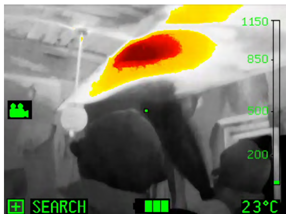
Bild 88. Vatten som sprutas mot de heta punkterna syns i kameran med svart färg.
