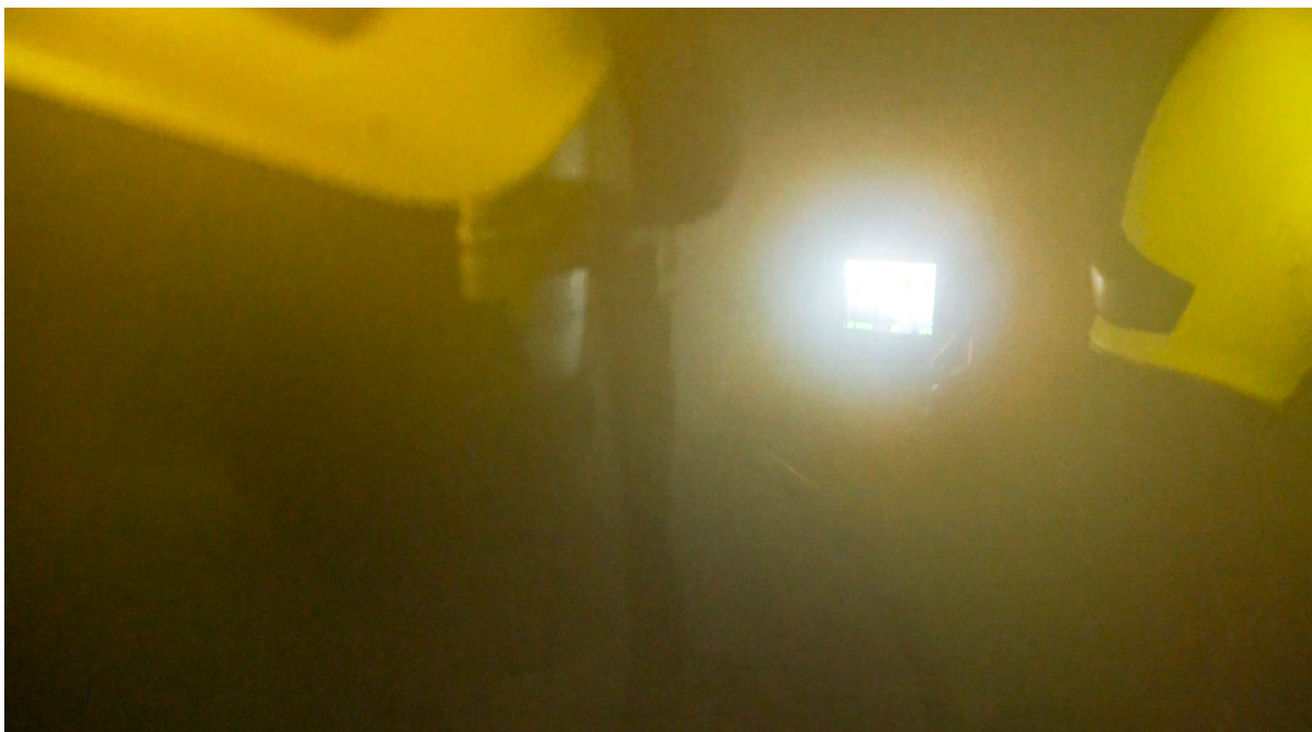
Bild 61. Vattenånga stör värmekamerans bild.
