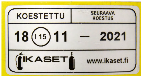
Bild 32. Kontrollintervall för tryckluftsbehållaren.
