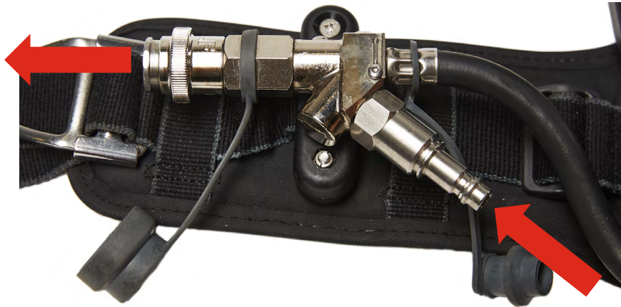
Bild 56. Riktning för matning av tilläggsluft (Dräger).
