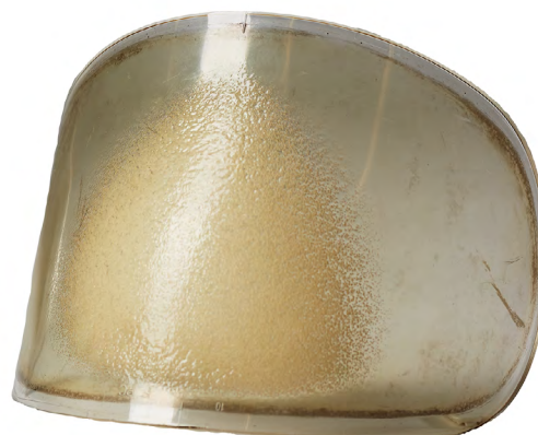
Bild 41. Ett skadat visir.
