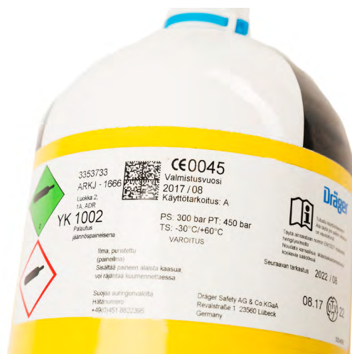
Bild 31. Märkning på en tryckluftsbehållare.
