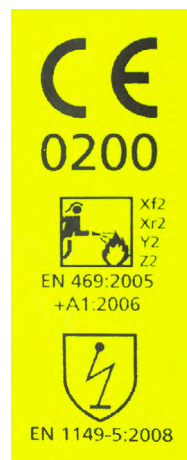
Bild 7. Exempel på ett märke för typgodkännande för en släckningsdräkt.
