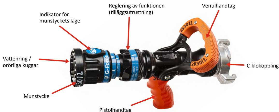
Bild 65. Strålrörets delar.
