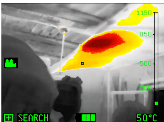
Bild 87. Med värmekameran upptäcker man heta punkter vid eftersläckningen.
