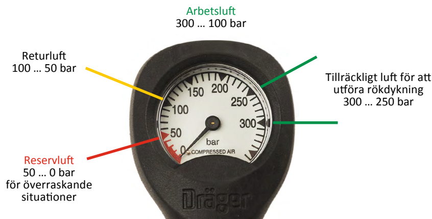
Bild 37. Luftens användningsområden beroende på luftmängden (6 l behållare).
