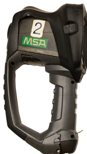
Bild 58. Värmekamera avsedd för rökdykning.
