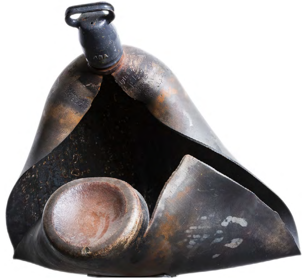
Bild 51. Gasbehållare som exploderat.
