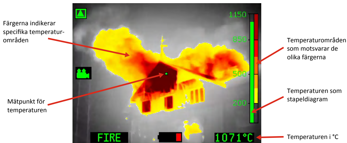
Bild 59. Temperaturmätning med värmekamera.
