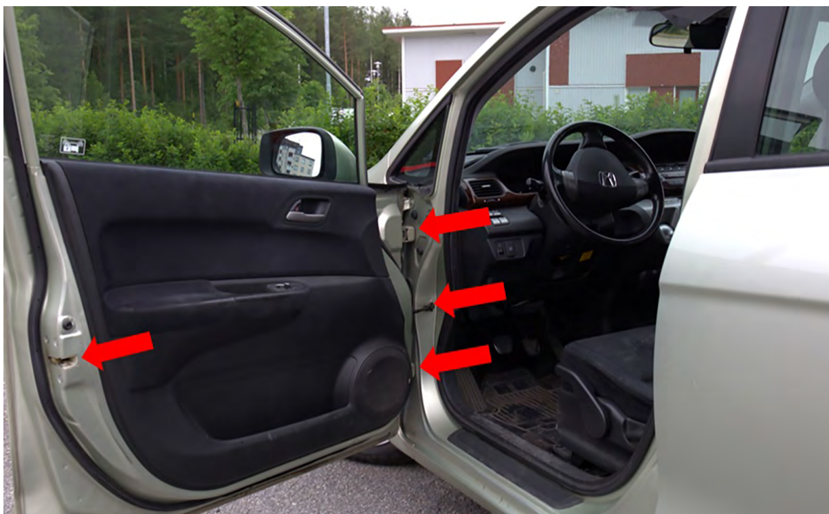
Bild 21. Dörren sitter fast i fyra punkter: de röda pilarna visar var låset, säkerhetsspärren och gångjärnen finns.
