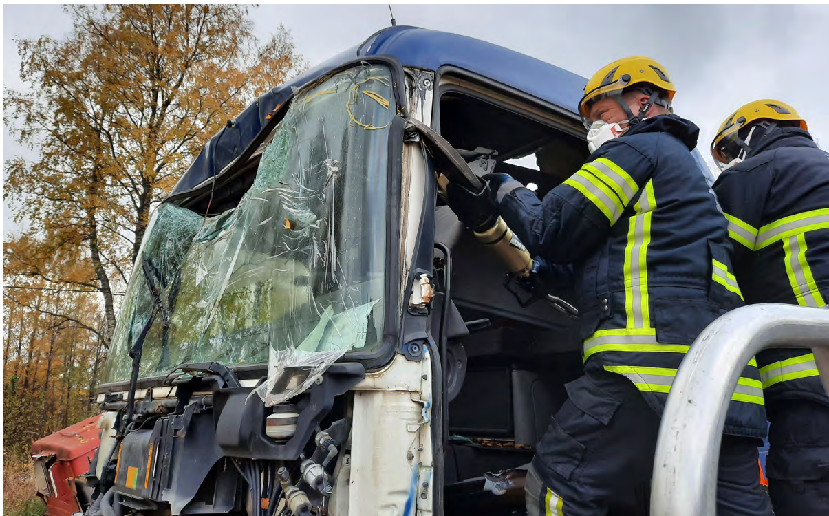
Bild 53. A-pelaren kan kapas med skärare eller tigersåg. Om man har för avsikt att skjuta undan pelaren efter klippning/kapning ska kapningsvinkeln vara sådan att pelaren inte kilar fast.
