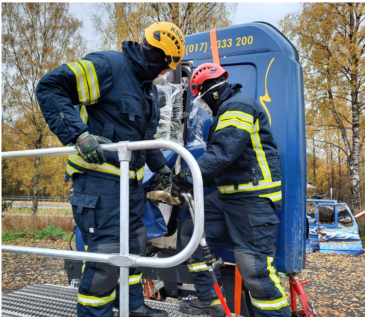
Bild 48. När man öppnar dörren ska man observera att den väger mycket och att man har de hjälpredskap som behövs för att hissa ner den.
