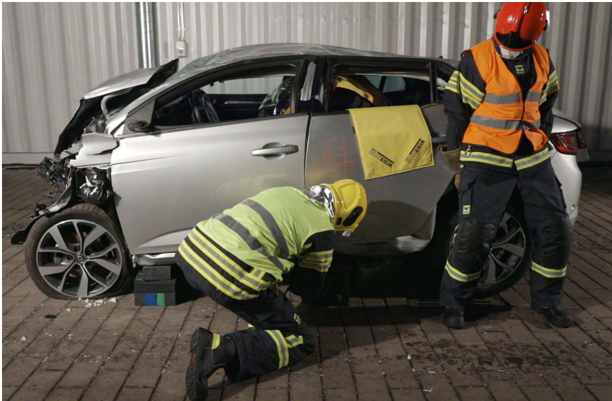
Bild 9. Genom att lyfta bilen i hjulbågen kan man få stödklossarna bättre och stadigare på plats.
