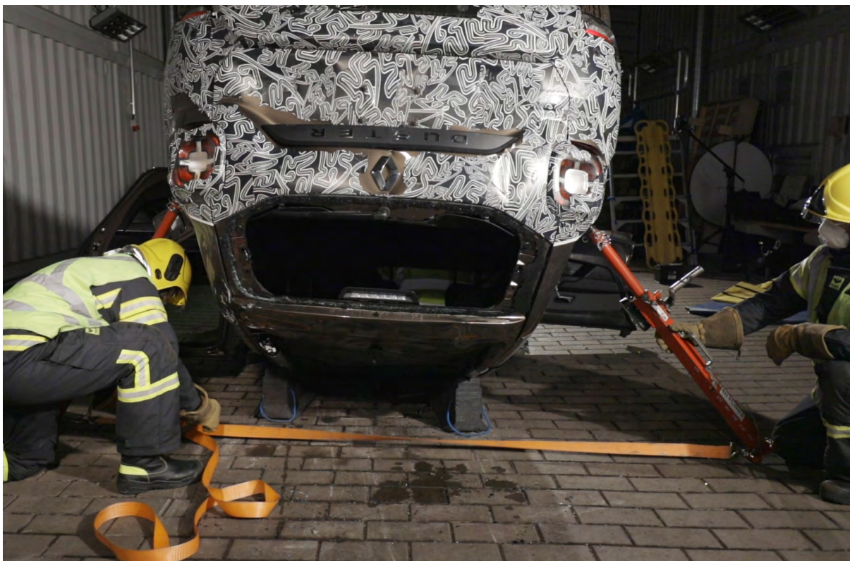
Bild 11. En personbil har stöttats med justerbara fällriktare för att förhindra rörelse i sidled. En lastrem mellan fällriktarna förhindrar att de glider åt sidorna. Dessutom finns det stödklossar under bilens tak för att förhindra att bilen "gungar" i längdriktningen.
