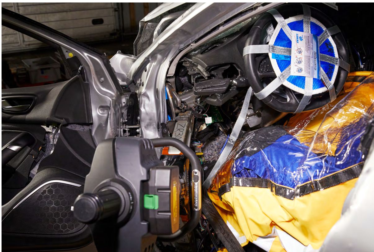
Bild 39. Skydda den räddade och frigör fötter som är i kläm med en spridare.
