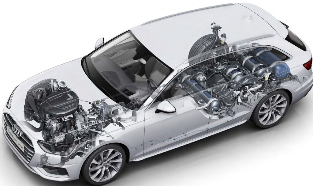
Bild 35. Genomskäring av en gasdriven personbil (Audi A4 Avant g-tron, bild: Audi AG).
