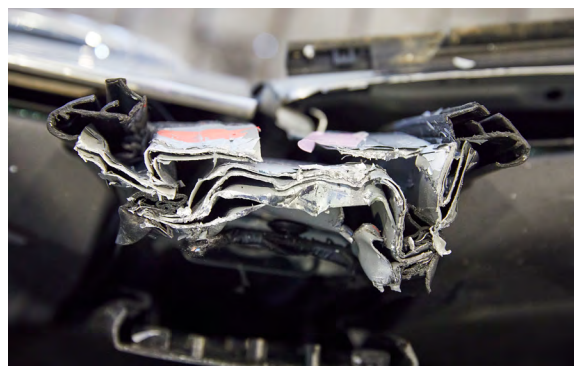
Bild 14. En B-pelare som har kapats med en skärare.
