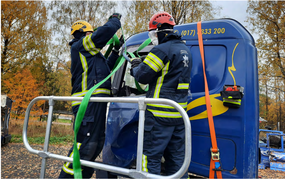
Bild 49. Dörren surras med en rem så att den kan hissas ner till kontrollrat.
