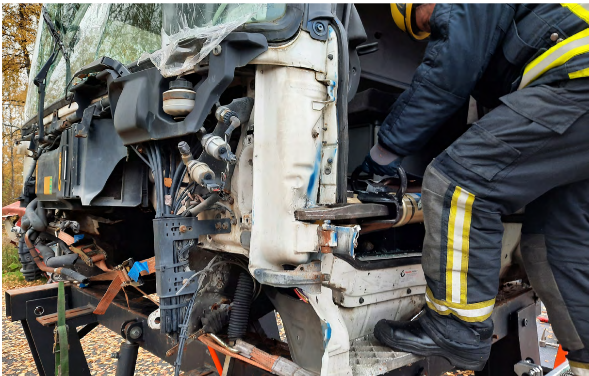
Bild 52. Försvagande klippning görs vid behov på A-pelaren.
