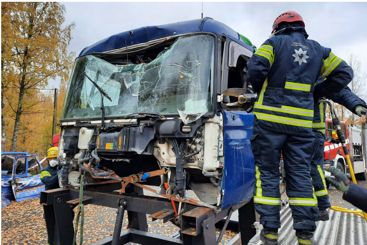
Bild 50. Om den räddade inte kan fås ut via dörren skapar man mer utrymme genom att kapa gångjärn och kablar.
