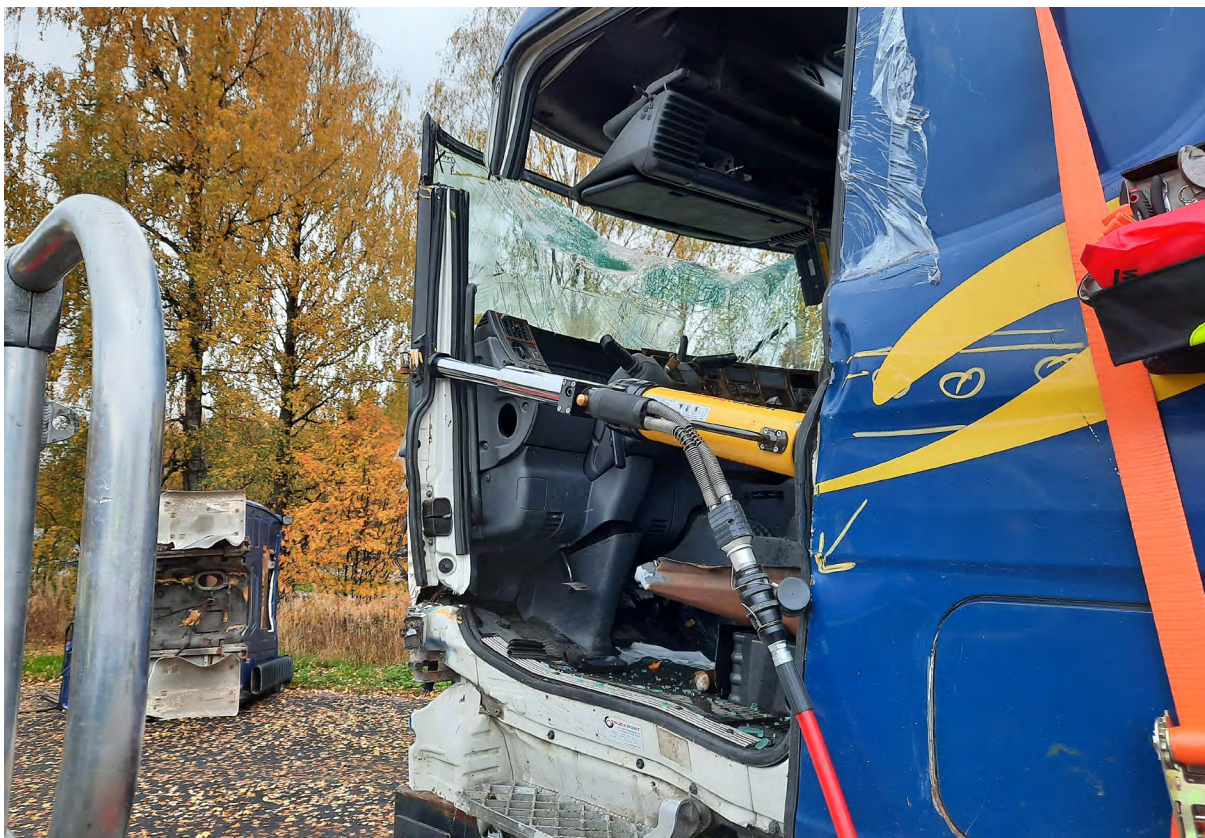
Bild 54. Använd en stångspridare för att skapa tillräckligt med utrymme för att förflytta den räddade.
