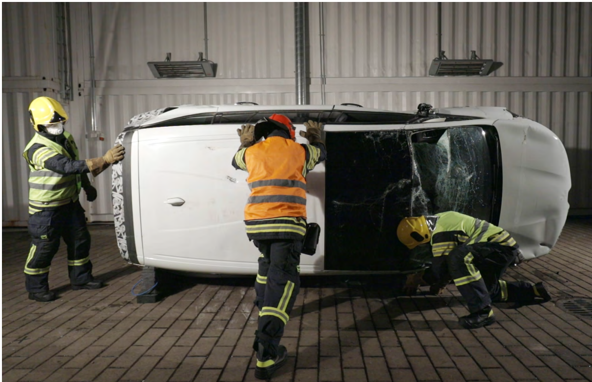
Bild 10. Stöttande av en personbil som står på sida.
