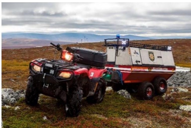
Kuva 8. Lapin pelastuslaitoksen mönkijän perään laitettava metsäpalon sammutusvaunu
