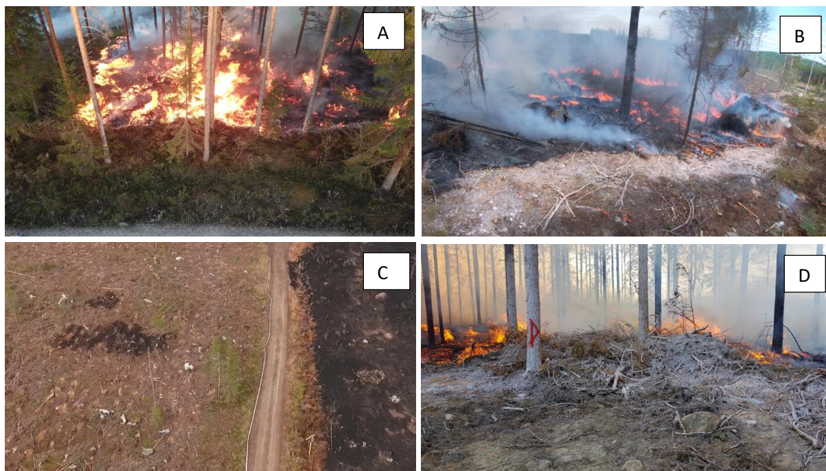
Kuva 65. Hieman punertavana näkyvä kaistale ennaltaehkäisyainetta kulotusalueella 1 (A). Noin metrin levyinen käsitelty kaistale kulotusalueella 2 (Aine muuttui kuivueessaan vaaleaksi) (B). Rajoituslinjana tie sekä käsitelty alue sekä linjan yli lentäneen heitteen aiheuttama palo kulotusalueella 3. (C) Ennaltaehkäisyaineella käsitelty hakkuujätekas kulotusalueella 3 (D).
