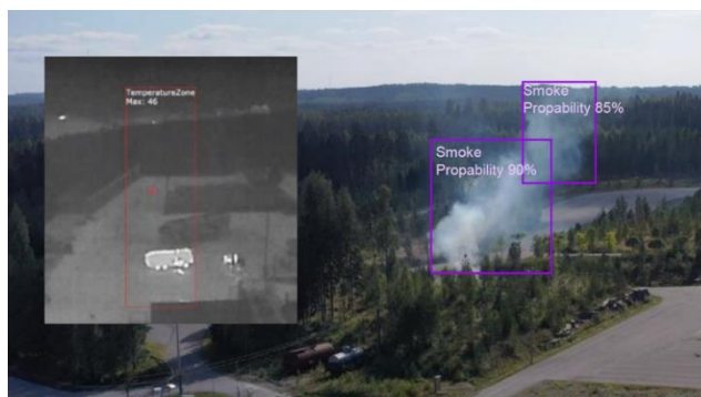
Kuva 23. Kameran kuvaamaa materiaalia ja tekoälyn päätelmiä metsäpaloön liittyvän savuntuotannon todennäköisyydestä (Kuva Telia).
