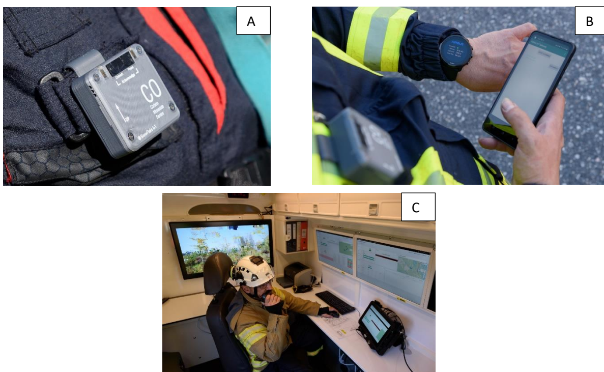
Kuva 63. Tilannekuvajärjestelmään iot-tekniikan avulla liitetty häikäsensori sammutusasuihin kiinnitettynä A, Sammuttajan sykkettä ja häikäpitoisuuksia mittaavat laitteet sekä taustajärjestelmään yhteydessä oleva älypuhelin B, Tilanteen seuranta johtoautossa C. (kuvat Jouni Kemppainen)
