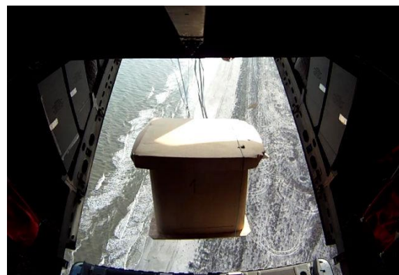
Kuva 10. Sammutuskuutio metsäpalojen sammutukseen (Caylym)
