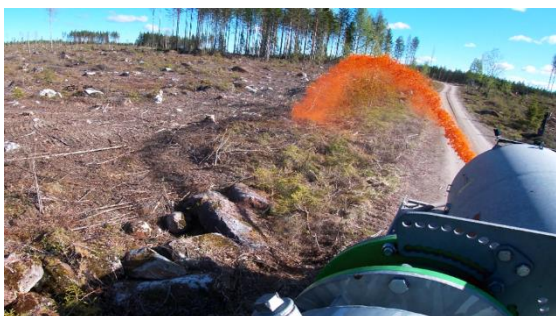
Kuva 21. Lietevaunun imupumppu, levitysmäärän esitestaus, levitys metsäautotien viereen ja hakkuujätekasaan.
