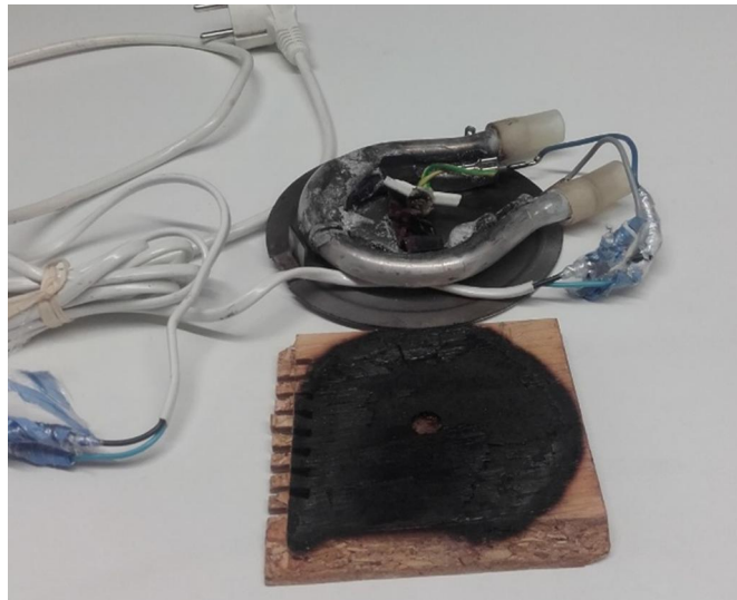
Kuva 3. Asukkaalta takavarikoitu keittolevy (nurinpäin) alustoineen. (Kuva Pirkanmaan pelastuslaitos)
