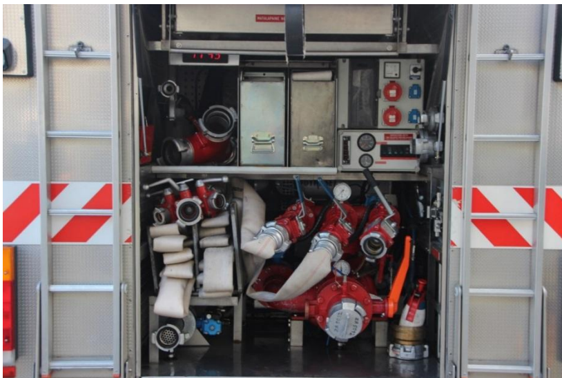
KUVA 2. Vuorojakoliitin ja pääjohdot ensivaste-sammutusauton takakaappiin sijoitettuna (kuva: Sami Pelkonen)
