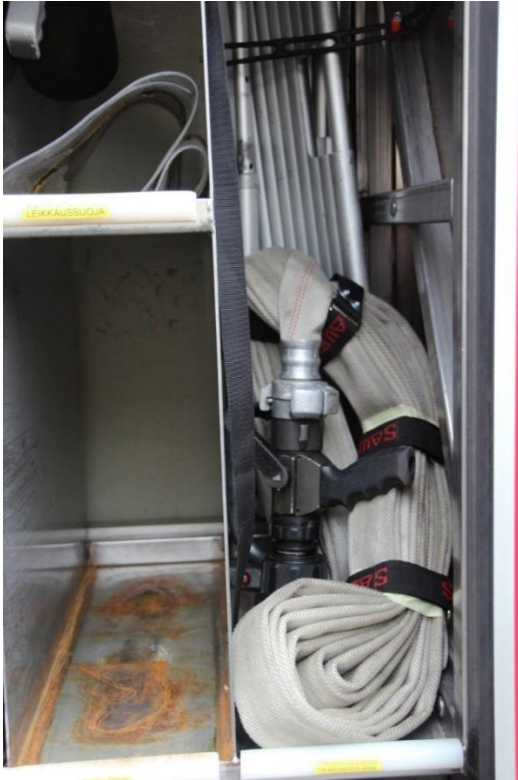
KUVA 3. "Patonki" sijoitettuna ensivaste-sammutusauton kalustokaappiin kolme (kuva: Sami Pelkonen)
