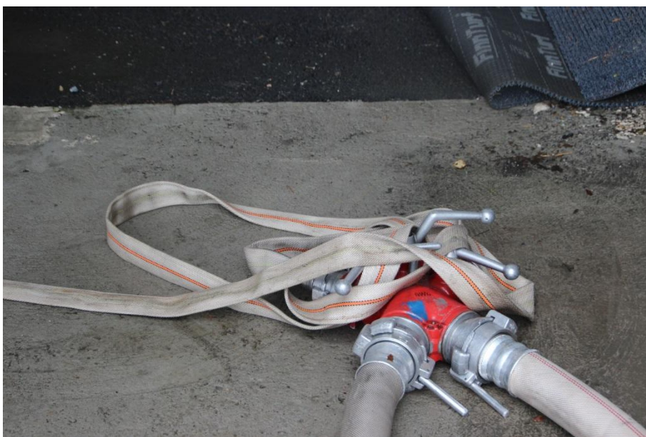
KUVA 23. Työjohto on sotkeutuneena vuorjakoliittimeen (kuva: Sami Pelkonen)
