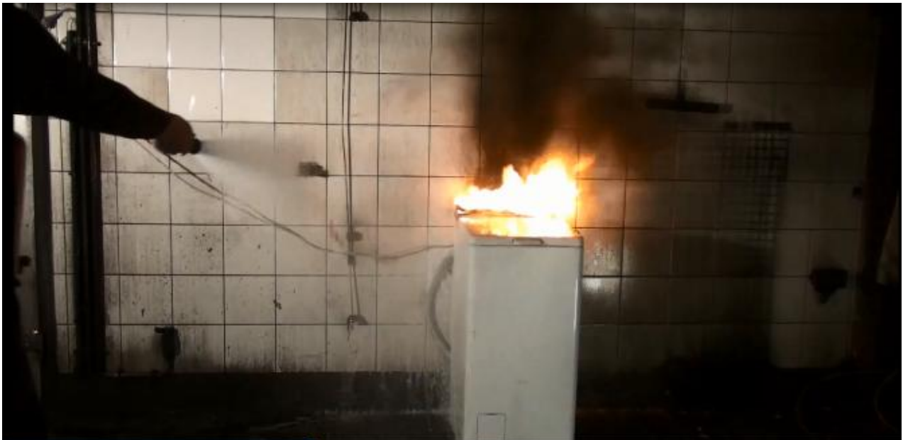
Kuva 7. Pesukoneen palon sammutus vaahtosammuttimella
