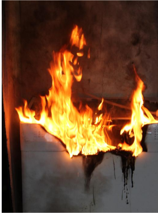
Kuva 4. Astianpesukoneen poltto. Syttymiskohta etupaneelin ohjelmakoneisto
