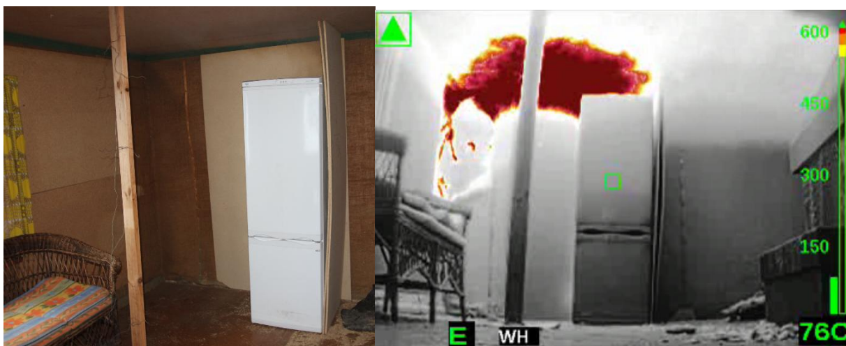
Kuva 2. Tutkittava jääkaappipakastin sekä lämpökamerakuva poltosta
