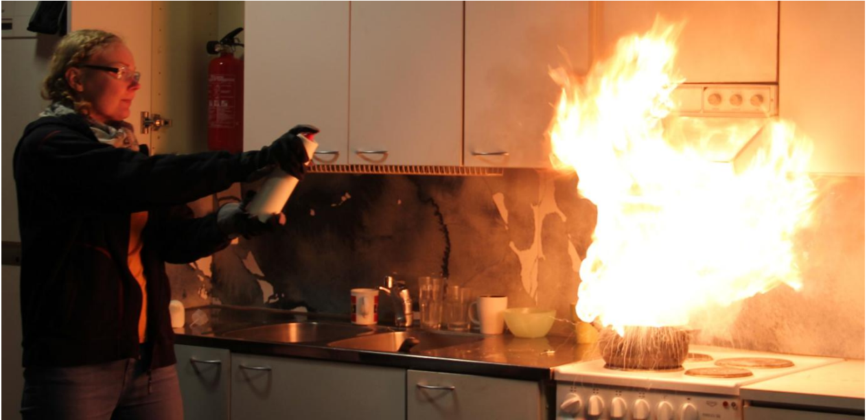
Kuva 6. Rasvakattilan sammuttaminen design sammuttimella.
