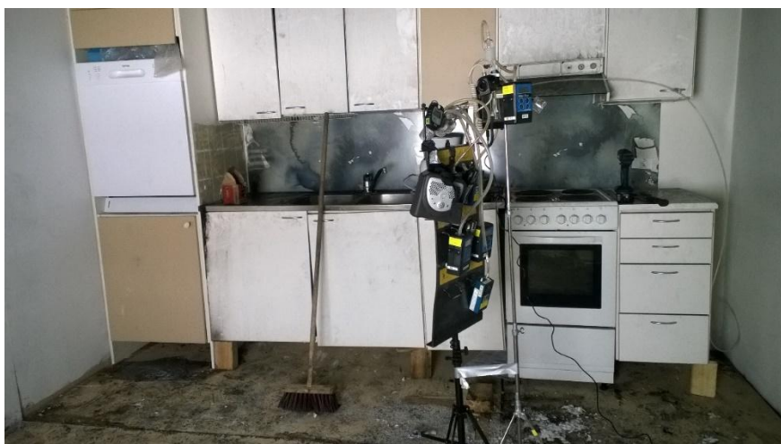
Kuva 2. Hirsitalosimulaattoriin rakennettu keittiö, poltettava pesukone ja kiinteä mittauspiste
