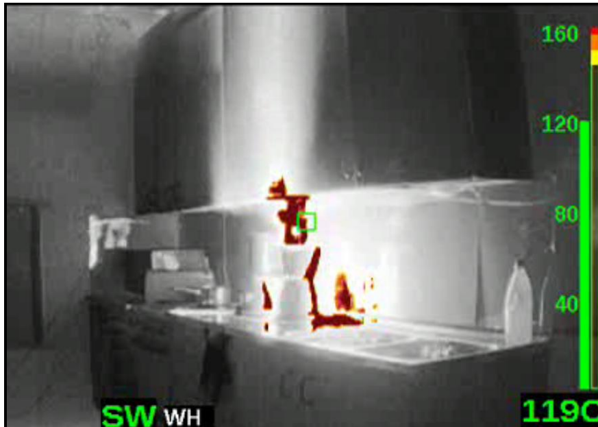
Kuva 3. KahvinkeitTIMEN palon leviäminen kaapistoon
