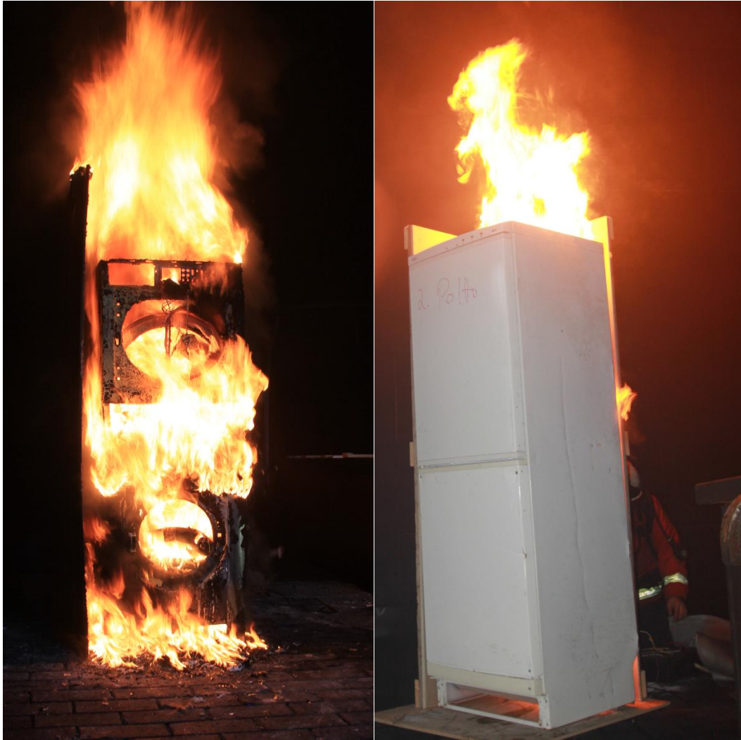
Kuva 5. Pesutornin (pesukone + kuivausrumpu) ja jääkaappipakastimen täyspoltot
