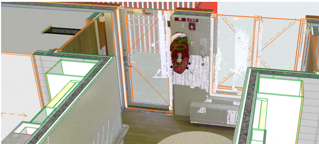
Kuva 6. Pistepilvi arkkitehtimallinnusohjelmassa (Rautiainen ym. 2021).
