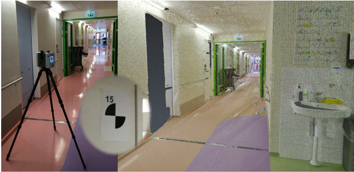
Kuva 5. Laserkeilain, tähys ja pistepilvi (Rautiainen ym. 2021).
