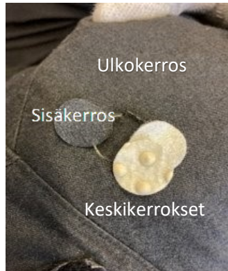
Kuva 3. Näytteet LION-palopuvun niskasta, selästä sekä rinnasta. Selän kuvissa merkitty palopuvun eri kerrokset: Ulkokerros, kosteudelta ja lämmöltä suojaavat keskikerrokset sekä sisäkerros.
