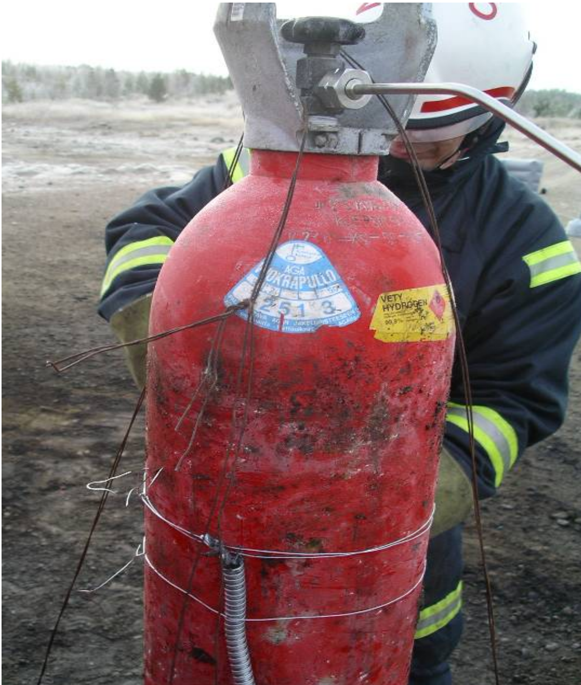
Kuva 3a. Lämpötila-anturin ja paineanturille vievän putken kiinnitykset pulloon
