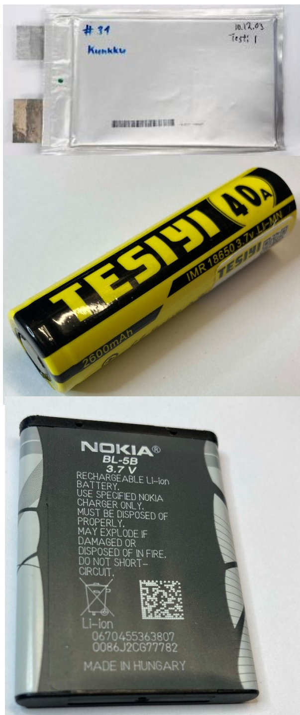
Kuva 1. Pussikkenno, sylinterikkenno ja prismaattinen akku
