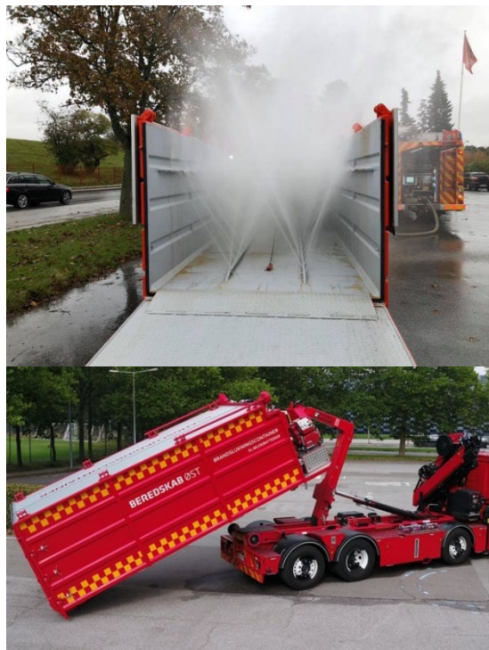
Kuva 43. Sammutuskontti, jossa vettä kierrätetään. Kuva Beredskab Øst
