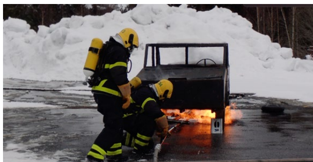
Kuva 34. Ajoneuvon akun jäähdyttämien varsisammuttimella. Kuva: Pelastusopisto
