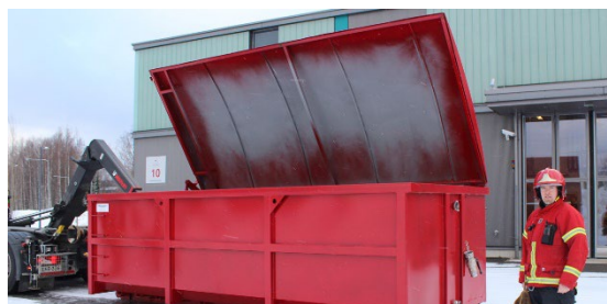
Kuva 42. Siirrettävä kontti ajoneuvon sammuttamiseen Kuva: Mika Rinne, Pelastustieto
