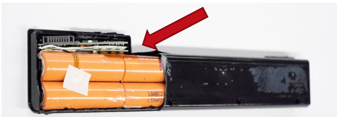
Kuva 3. Purettu kannettavan tietokoneen akku, akunhallintajärjestelmä merkitty nuolella.
