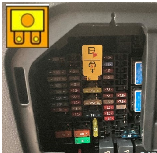
Kuva 21. Korkeajännitepiiriin erottava sulake (matalajännitteinen) Volkswagen ID.4 sulaketaulussa
