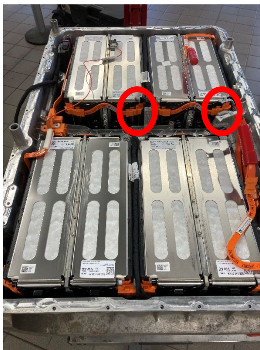
Kuva 14. Ladattavan hybridin akku osittain purettuna
