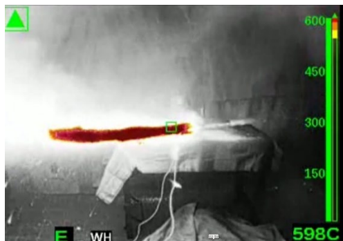
Kuva 5. Termisen karkaamisen liekkipalovaihe lämpökameralla kuvattuna
