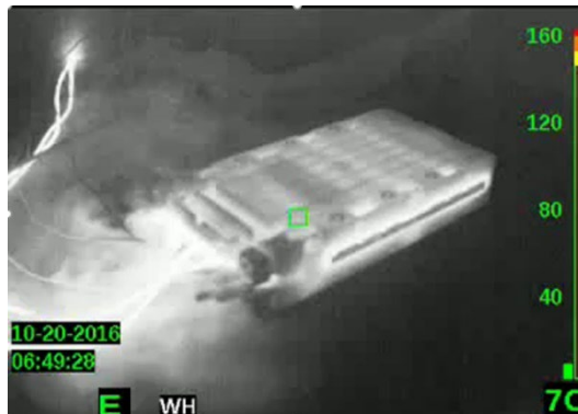
Kuva 4. Kaasujen purkautuminen akkukennosta
