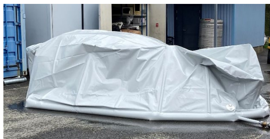
Kuva 45. Suodatinratkaisun ja jäähdyttämisen yhdistävä sammutuspeite sähköautoille
